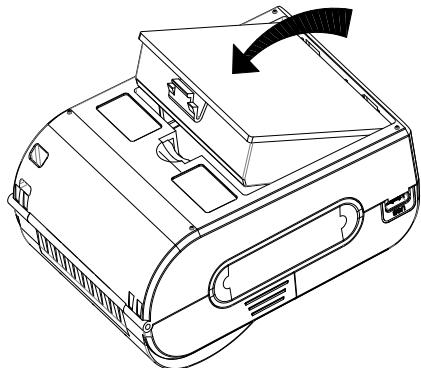
1、将电池按照如上图所示的方向放进打印机背面的电池仓，按压一下使电池扣紧
